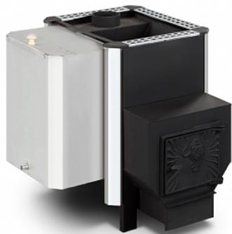
Печь оснащена баком из нержавеющей стали на 40л для нагрева воды. Бак вплотную прилегает непосредственно к топке печи, что делает нагрев воды очень быстрым. Возможно исполнение с левым баком (Т24БЛ) или с правым баком (Т24БП).
