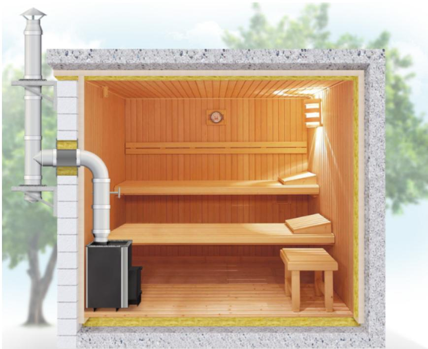
Дымоход нужен для вывода из печи побочных продуктов горения с помощью воздушной тяги и является неотъемлемой частью отопительного оборудования, печи или котла. Правильный выбор и монтаж увеличивают период эксплуатации, обеспечивают безопасное использование.
